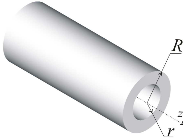
Рис. 1.91. К определению характеристик круглого полого вала
